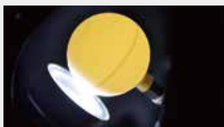
継ぎ目、外形をコンピューターでチェック
