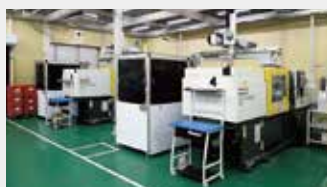
ボールの成形、接着を行う産業ロボット
