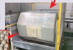
研磨石とともに回転させて研磨する
